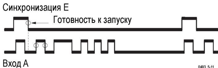
Если условия синхронизации не похожи на условия, показанные в вышеприведенном примере измерения, скажем, когда задний фронт сигнала синхронизации приходит слишком поздно, следует объединить подготовку синхронизации с задержкой времени, см. следующий рисунок.
