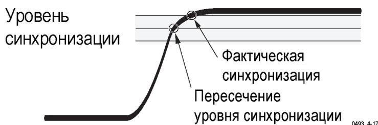
**Превышение уровня синхронизации.** Когда входной сигнал пересекает полосу гистерезиса, лишь незначительно превышая ее, синхронизация может произойти на какие-нибудь 100 пс позднее, чем обычно. Заявленная для наихудшего случая систематическая погрешность синхронизации 500 пс включает в себя эту составляющую. Для минимизации этой погрешности следите, чтобы уровень синхронизации входного сигнала имел разумный запас на превышение.
