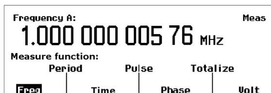
Типичные измерения включают в себя частоту, период, время, импульс, фазу, суммирование (только для приборов серии FCA3100) и напряжение в вольтах. Содержимое меню измерений зависит от модели прибора и его конфигурации.
