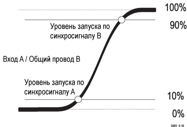
Прибор вычисляет и устанавливает уровни синхронизации. Время нарастания и спада может измеряться как на входе А, так и на входе В.
